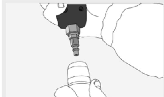
3. Una vez cargada la pistola, desconectar del cargador y conectar a la línea de aire.
